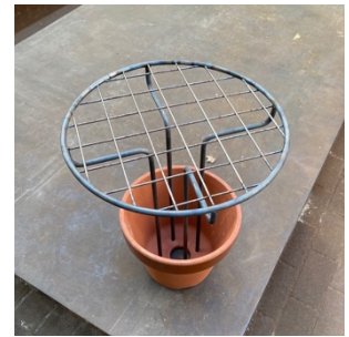
図11. 座面と植木鉢の接合構造
